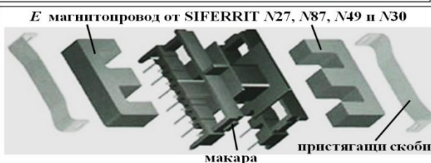
Фиг. 20. Конструкция на E магнитопровод и макара за него
